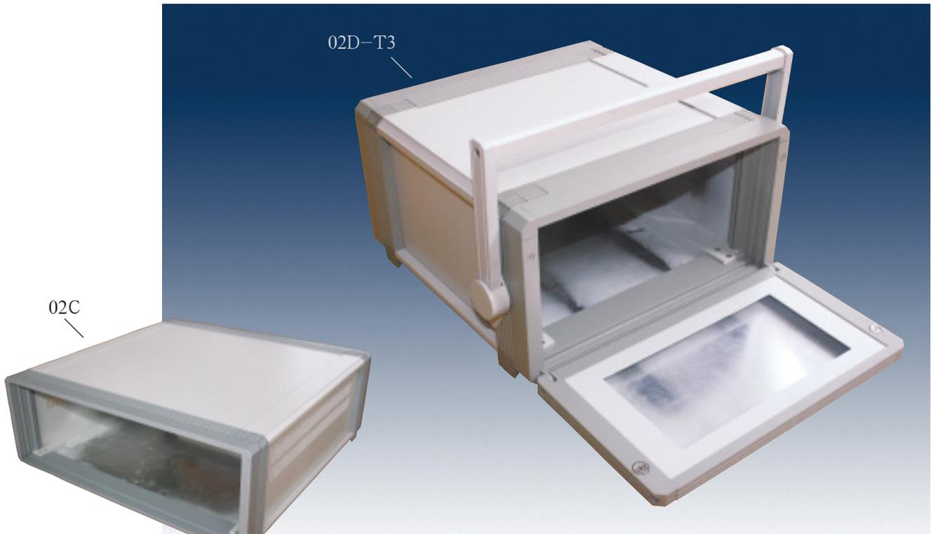
02C/02D型机箱由上下盖板、侧板、前后横梁、侧梁、面板型材等组成。02D配置有键盘托盘，机箱高度、宽度和深度方向规格可按要求任意定制。适合配置的提手有T3、T4、T5。
